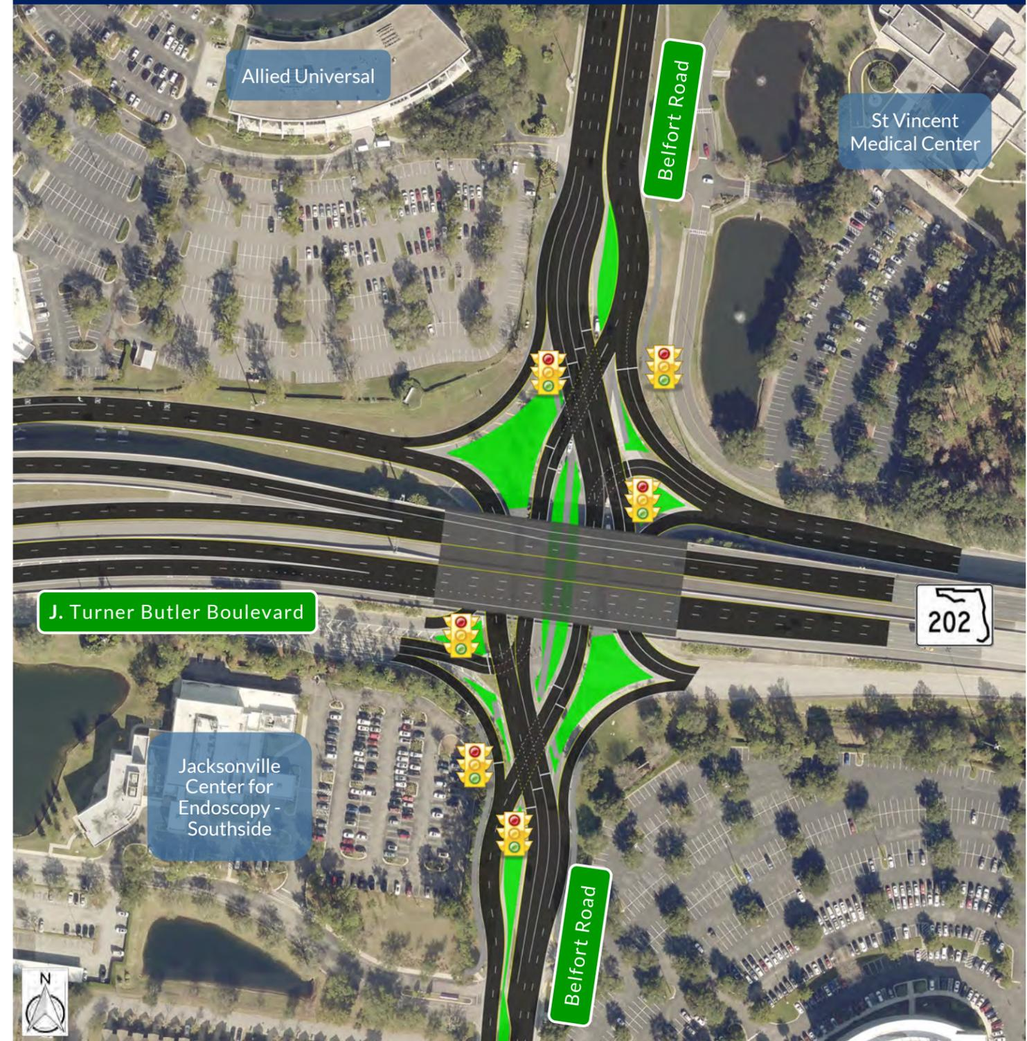
El intercambio de J. Turner Butler Boulevard con Belfort Road se convertirá en un intercambio de diamante divergente, como se muestra. Belfort Road se ampliará para dar cabida a dos carriles de paso y dos carriles de giro a la izquierda en ambas direcciones. Se eliminará el movimiento a través de las rampas de salida y se proporcionará un carril adicional de giro a la derecha para la rampa de salida en dirección oeste.
